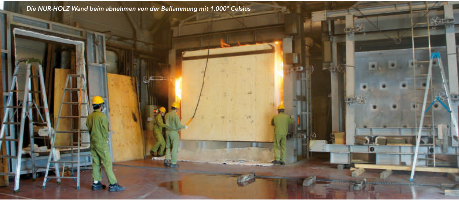
Nach einer Stunde Beflammung nur an der Oberfläche geringer Abbrand
