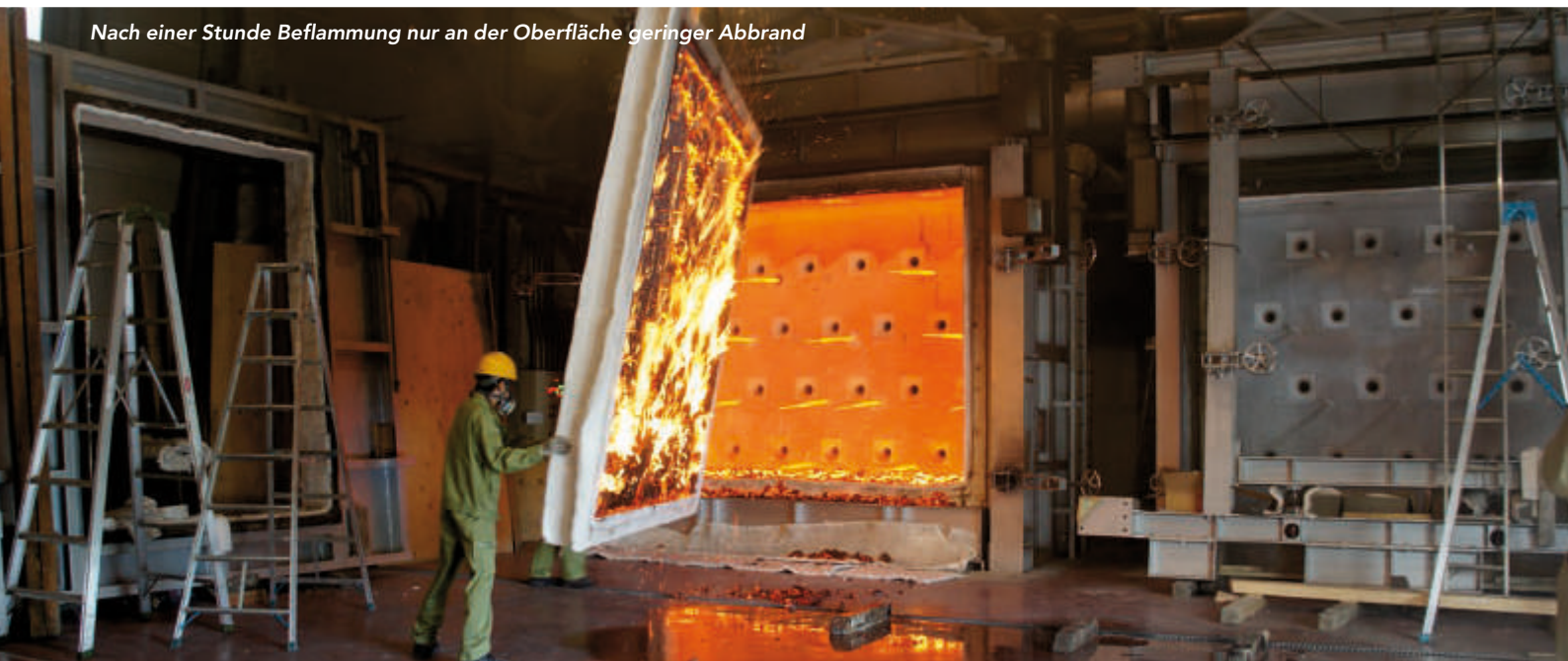
Nach Beflammung und vor Löschung nur geringe Feueraktivität
